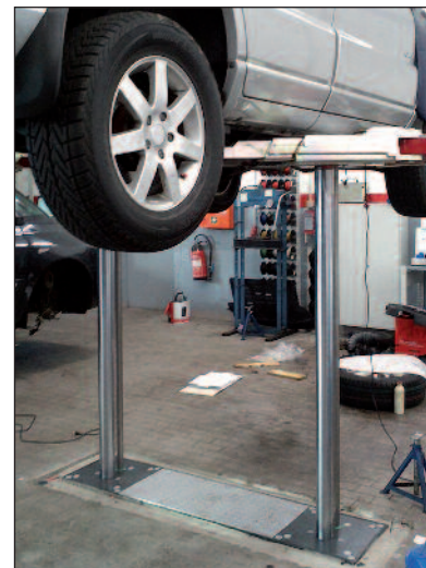
Hebebühne nach erfolgter Montage
