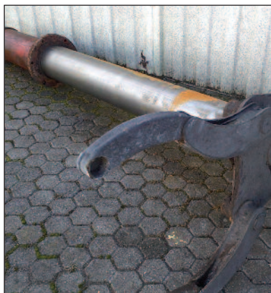
Ausgebauter alter Kolben mit Aufnahme
